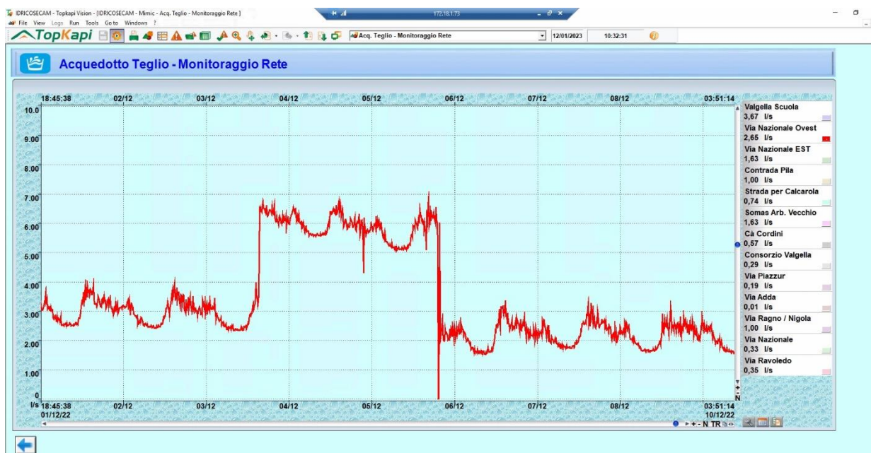
Figura 8: Utilizzo del telecontrollo nella ricerca perdite – esempio anomalia che segnala la presenza di una perdita
